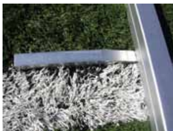
Figura 7. Equipo de evaluación de planimetría (regla y cala)
