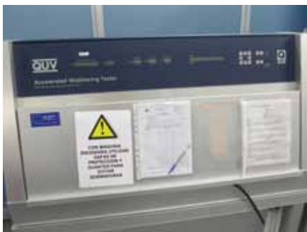
Figura 4. Equipo de envejecimiento climático
